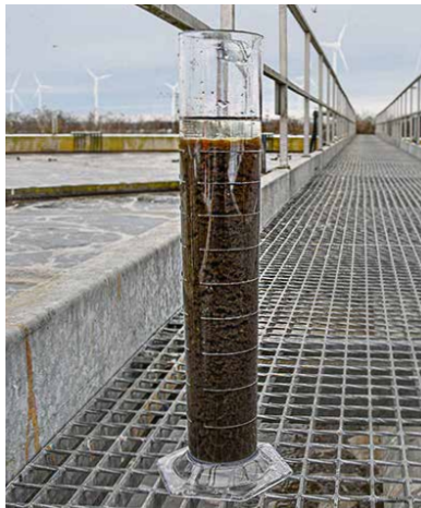
Im Belebungsbecken sind Bakterien die wichtigsten Mitarbeiter. Der Belebtschwamm sinkt später zu Boden. Oben entsteht klares, reines Wasser.
